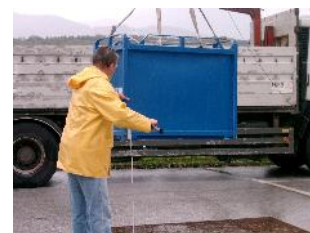
Test de chute (1,20 m) effectué sur une caisse acier pleine.
